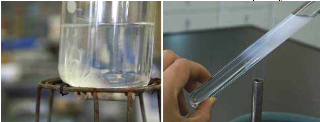
「非イオン界面活性剤」が加熱により白濁し、温まった水の動きが見える。
